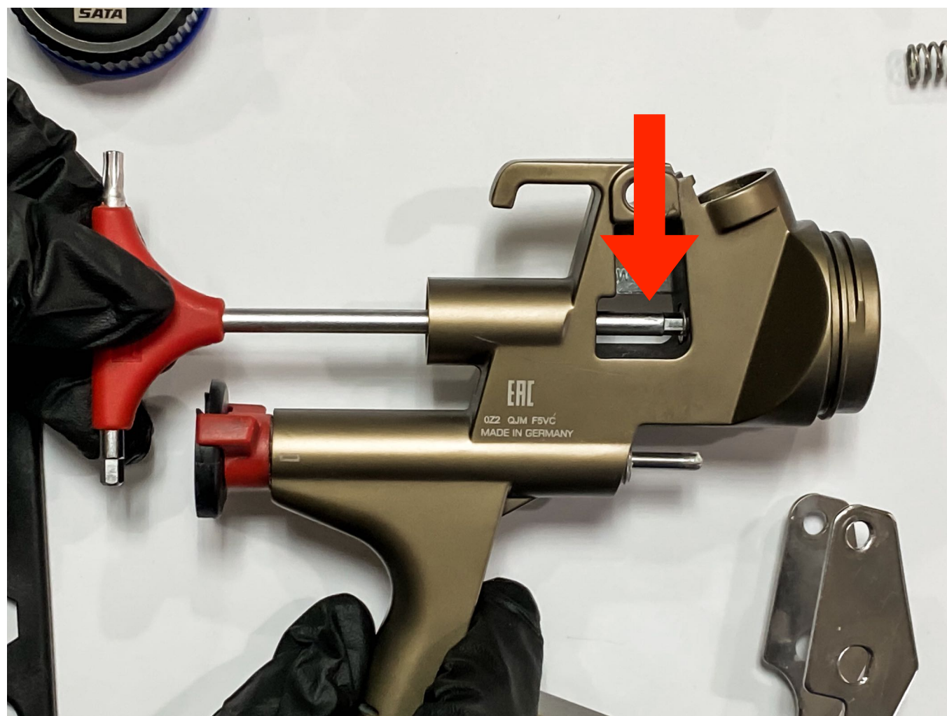
4. นำเครื่องมือรูปตัว T ใส้เข้าไปในช่องซิลิโคนจากด้านด้านหลังให้เข้าร่องแล้วหมุนทวนเข็ม
