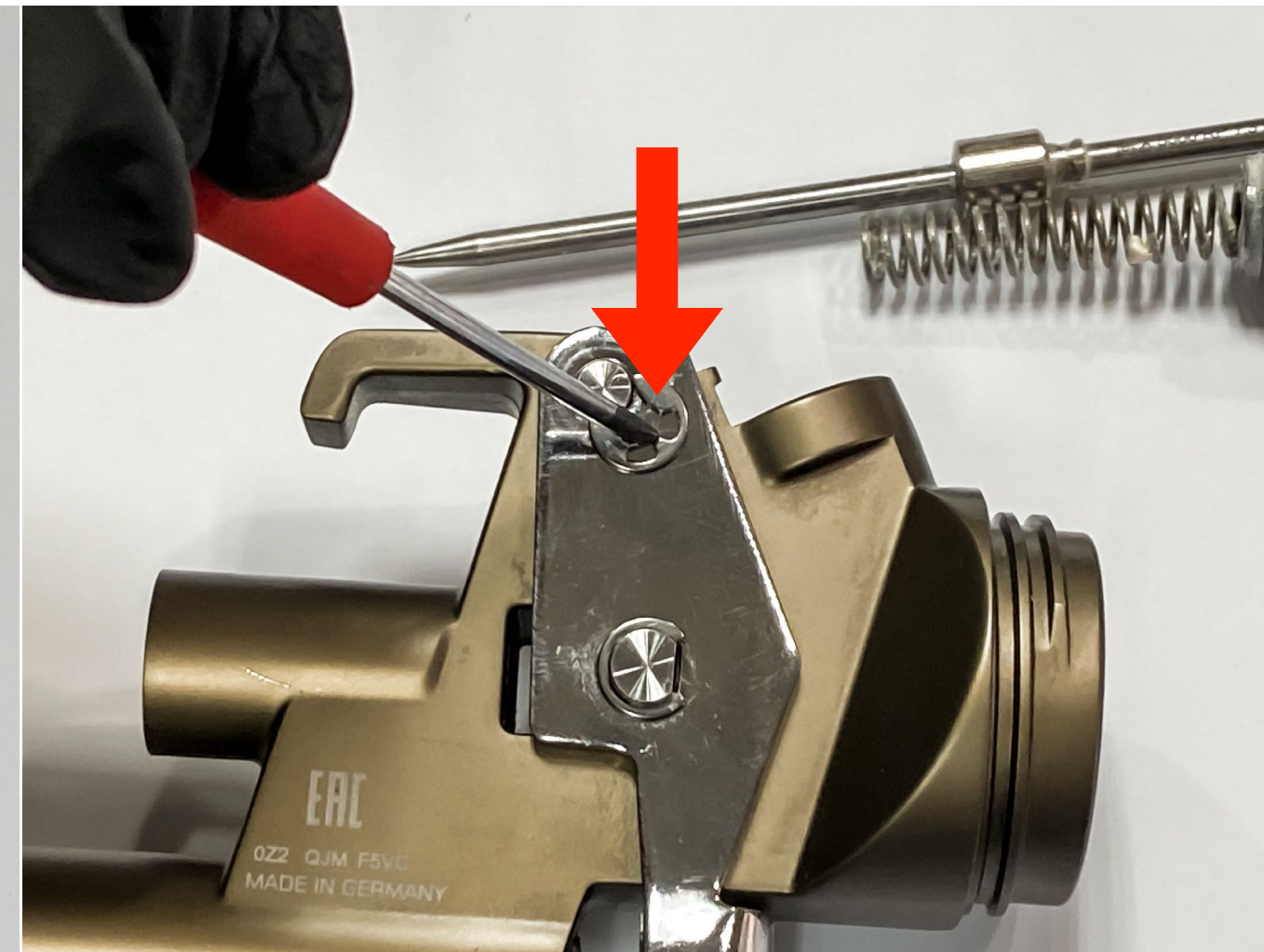
3. ใช้ไขควงแบนถอดสลักโกป็น และดึงโกป็นออก
