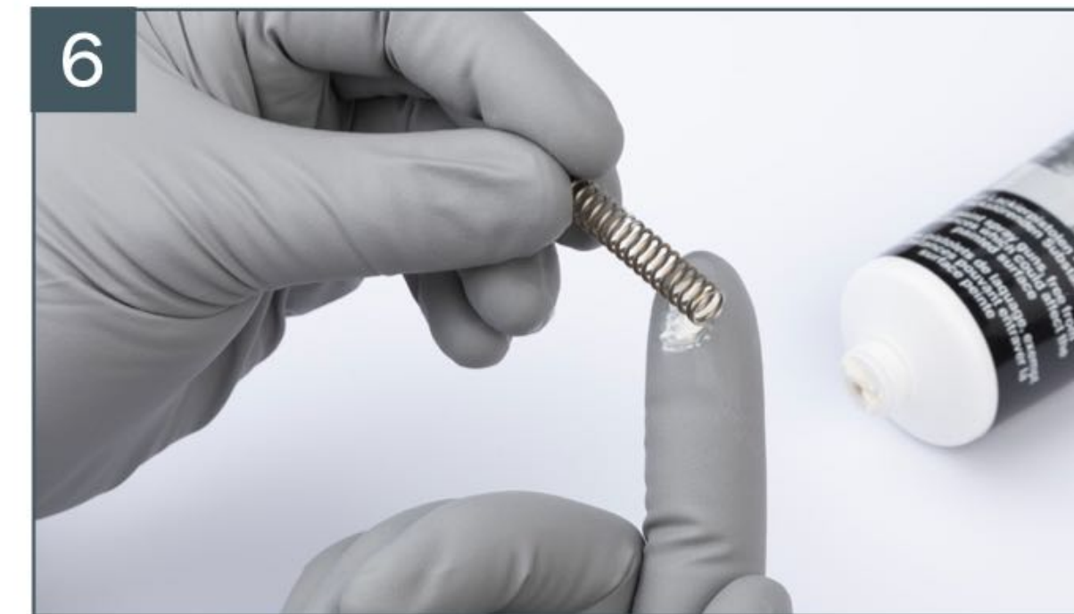
ทาจาระบี SATA ที่สปริงเข็มสี
