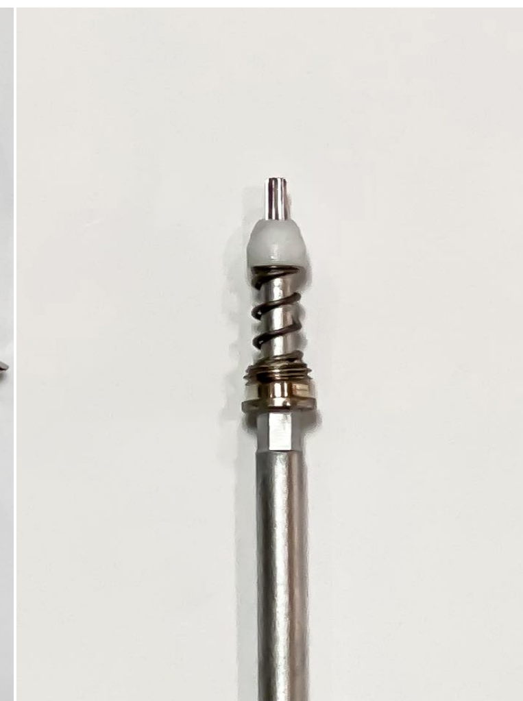
6. หากมีอาการสีรั่ว ให้เปลี่ยนซิลิโคนขาว
